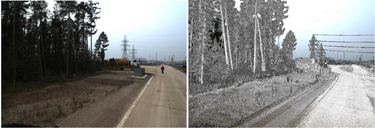
Рис. 10. Пример цифровой фотографии и соответствующим ей ТЛО Fig. 10. The example of a digital image and its corresponding point cloud
