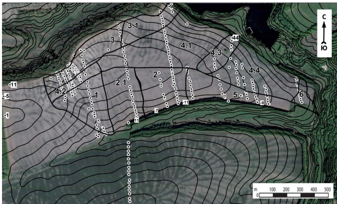
Рис. 3. Точки интегрального пробоотбора в слое 0–25 см на спутниковом снимке. 2.1 — номер участка; 11 — намыто (в случае «-» — смыто) см Fig. 3. Locations of integral (in the 0–25 cm layer) soil sampling in the satellite image. 2.1 — zone number; 11 — inwashed (in the case of “-” — outwashed) cm
