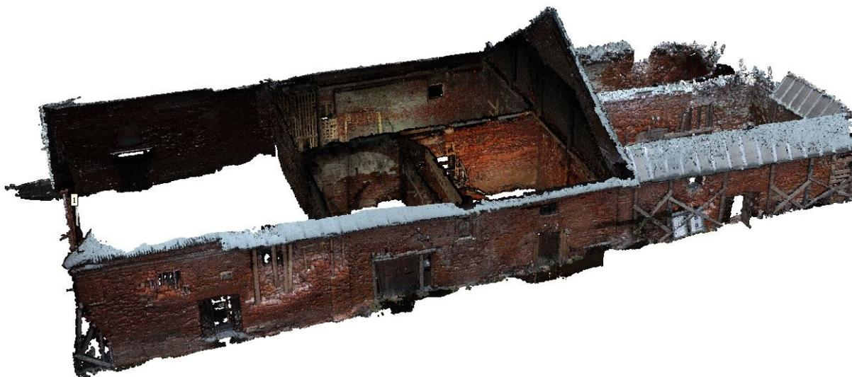
*Рис. 4. Финальная модель амбара в виде облака точек*
