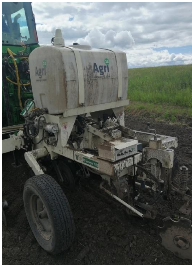
Рис. 2. Сканер Agri Veris в процессе сканирования почвы Fig. 2. Agri Veris scanner during soil scanning
