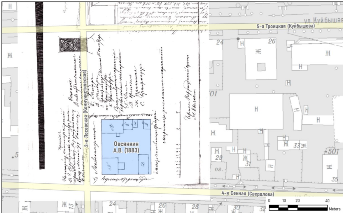
Рис. 3. Пример повторной привязки чертежа участка Fig. 3. Example of re-georeferencing a drawing of parcel
