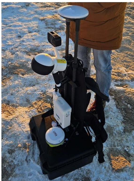
Рис. 4. Лазерный сканер LiGrip H300 (фото автора) Fig. 4. LiGrip H300 laser scanner (photo by the author)
