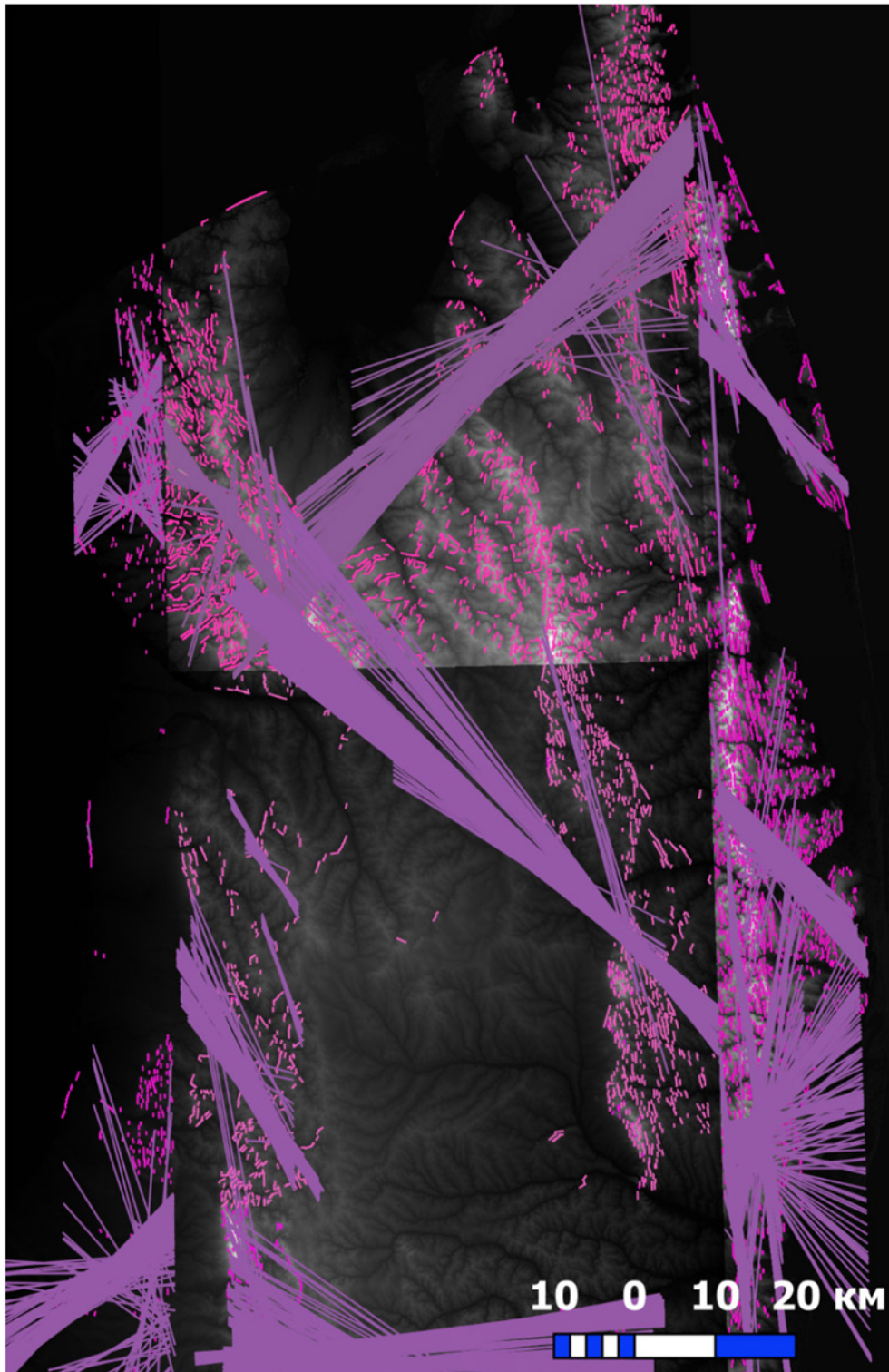
Рис. 2. Результат обработки SRTM Северо-Сахалинской равнины в программе LEFA посредством преобразований Хафа в режиме Canny many
