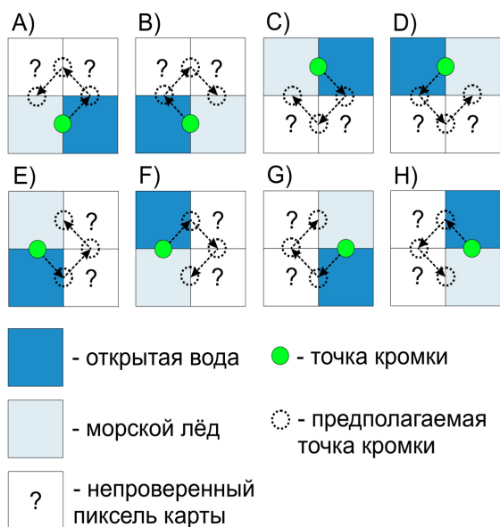
Рис. 2. Принцип поиска точек кромки льда Fig. 2. The principle of finding the points of the ice edge
