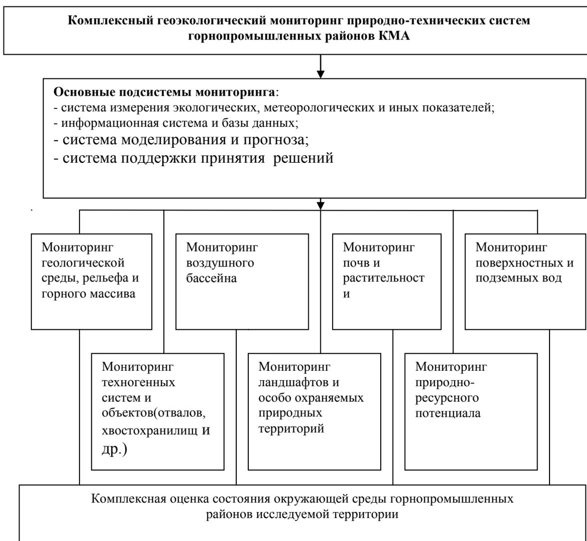
Рис.2. Структурная схема комплексного геоэкологического мониторинга природно-технических систем горнопромышленных районов КМА
