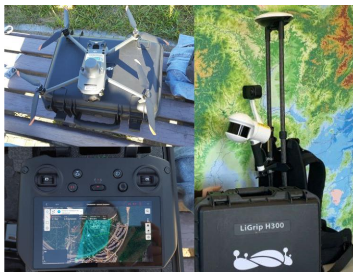
Рис. 2. Приборы, используемые в работе (слева — БВС, справа — наземный лазерный сканер с рюкзаком) Fig. 2. The devices used in the work (on the left — the UAV, on the right — the ground laser scanner with a backpack)
