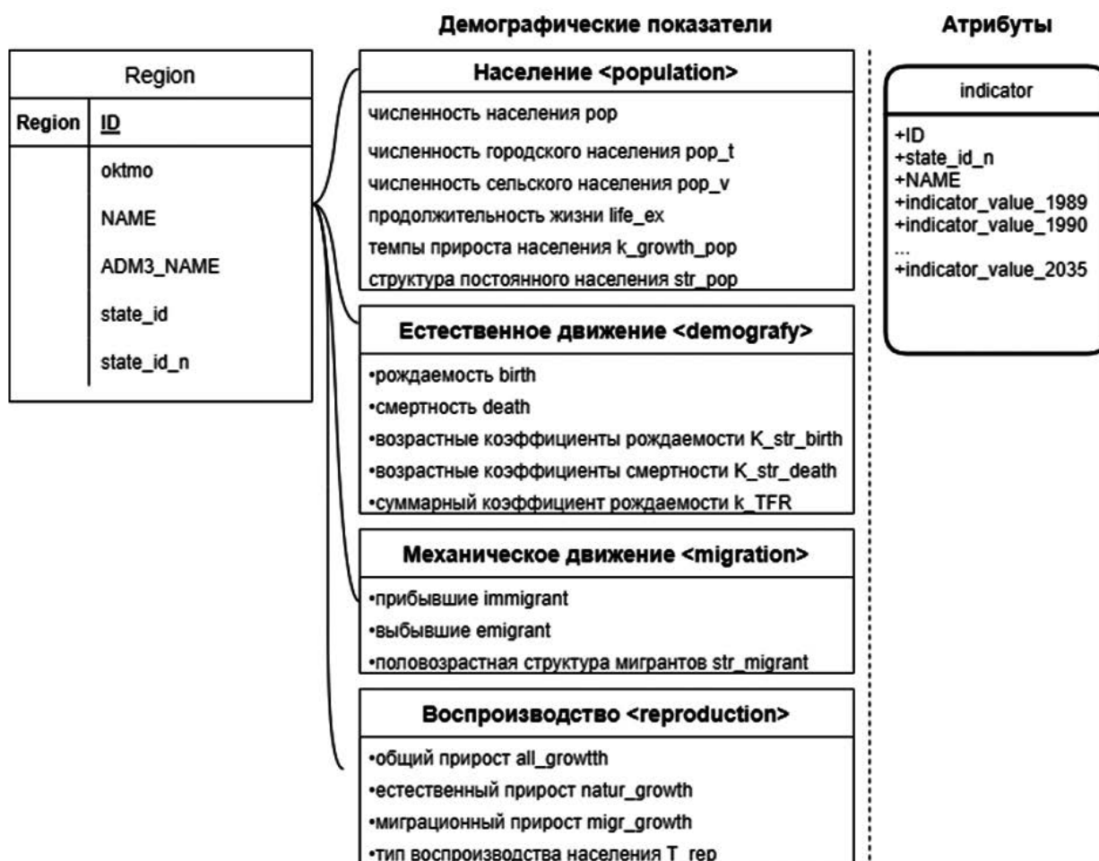
Рис. 2. Структурная схема базы пространственных данных системы геоинформационного мониторинга
