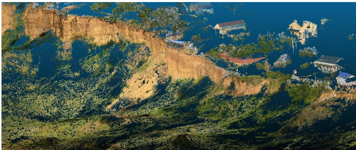
Рис. 5. 3D модель обвально-оползневых склонов в районе пляжа Учкueвка Fig. 5. 3D model of landslide and rockslide slopes near the Uchkuevka beach
