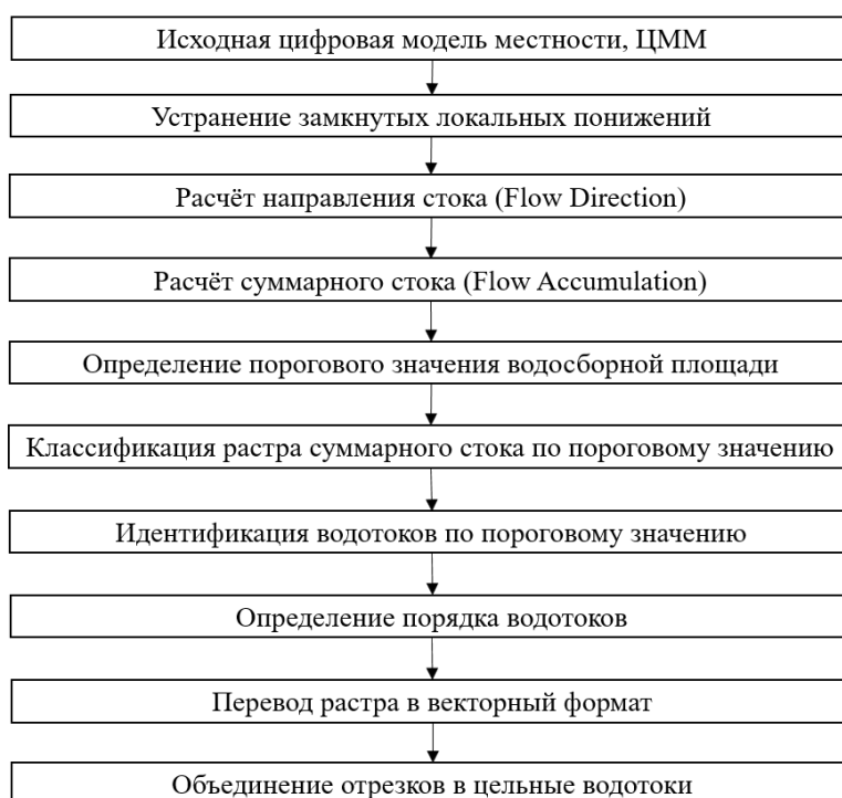
Рис. 1. Алгоритм выделения водотока инструментами геоинформационных систем Fig. 1. Algorithm of waterline delineation by tools of geographic information systems
