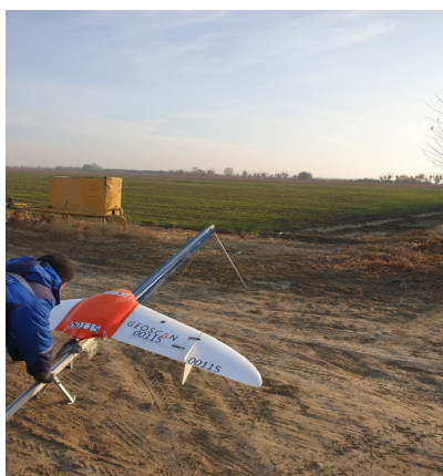
Рис. 5. Установка БПЛА Geoscan 201 на катапульту (подготовка к полету) Fig. 5. Installation of UAV Geoscan 201 on a catapult (preparation for flight)
