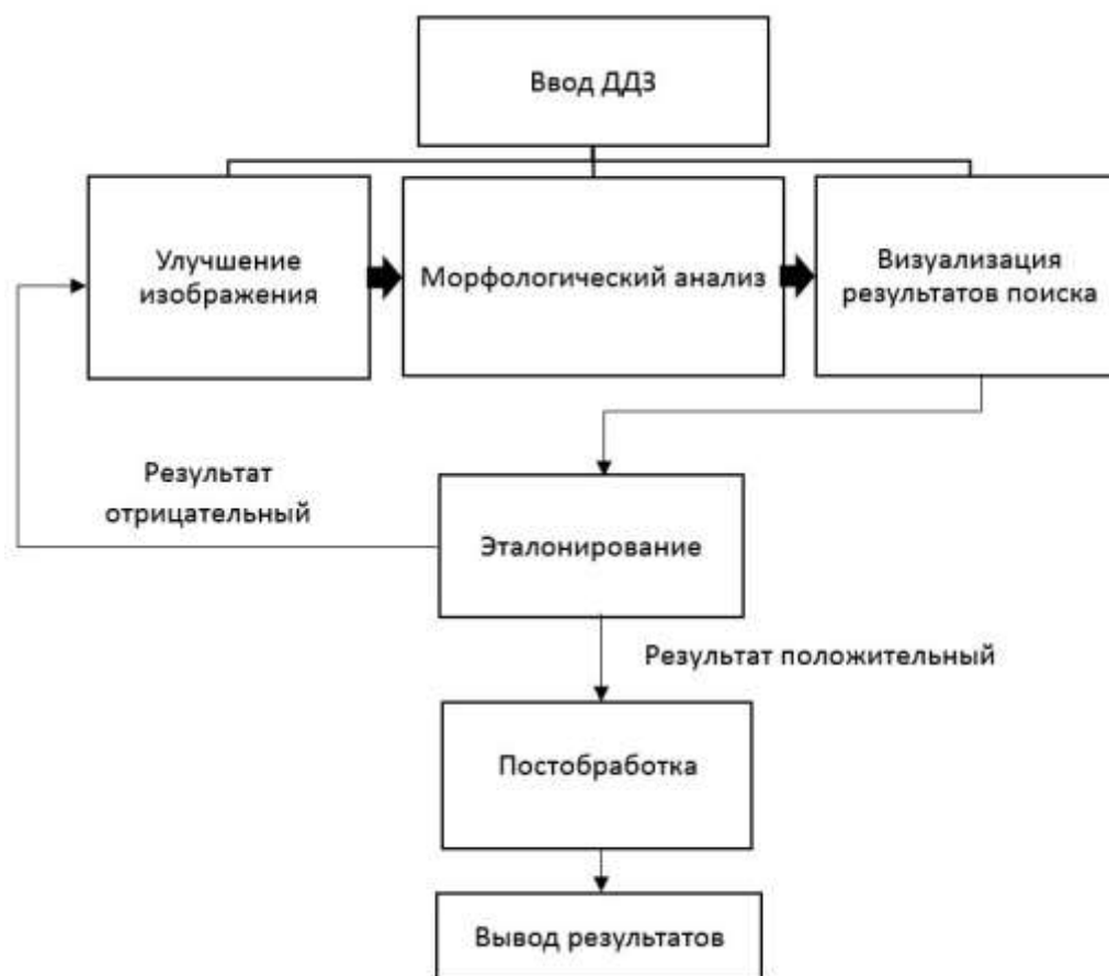
Рисунок 1. Алгоритмическая схема морфометрического дешифрирования Figure 1. The Algorithmic Scheme of Morphometric Decoding
