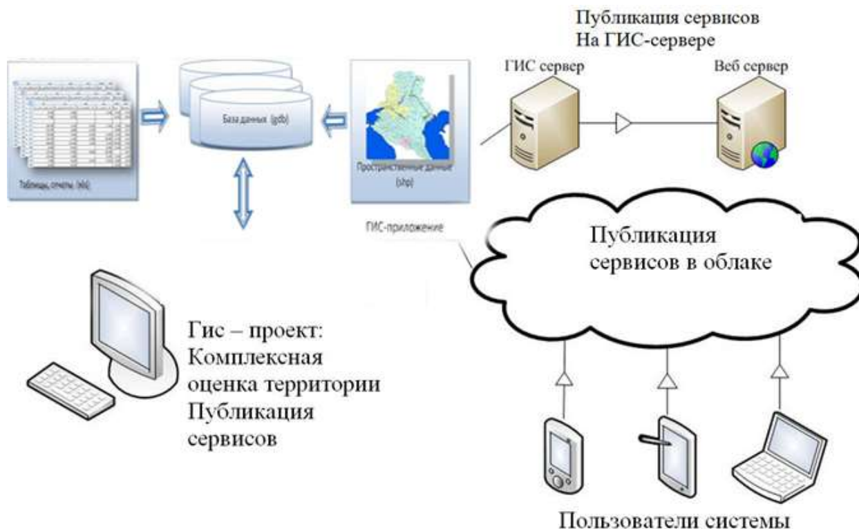
Рисунок 2. Принципиальная схема взаимодействия ГИС проекта и геопортала Figure 2. Schematic diagram of the interaction between the GIS project and the geoportals
