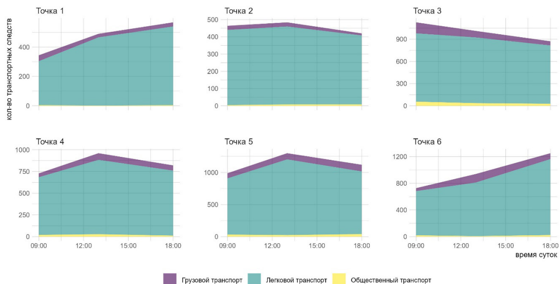
Рис. 6. Структура и интенсивность транспортных потоков днем в выходной день Fig. 6. Traffic flow structure and intensity during daytime in weekend
