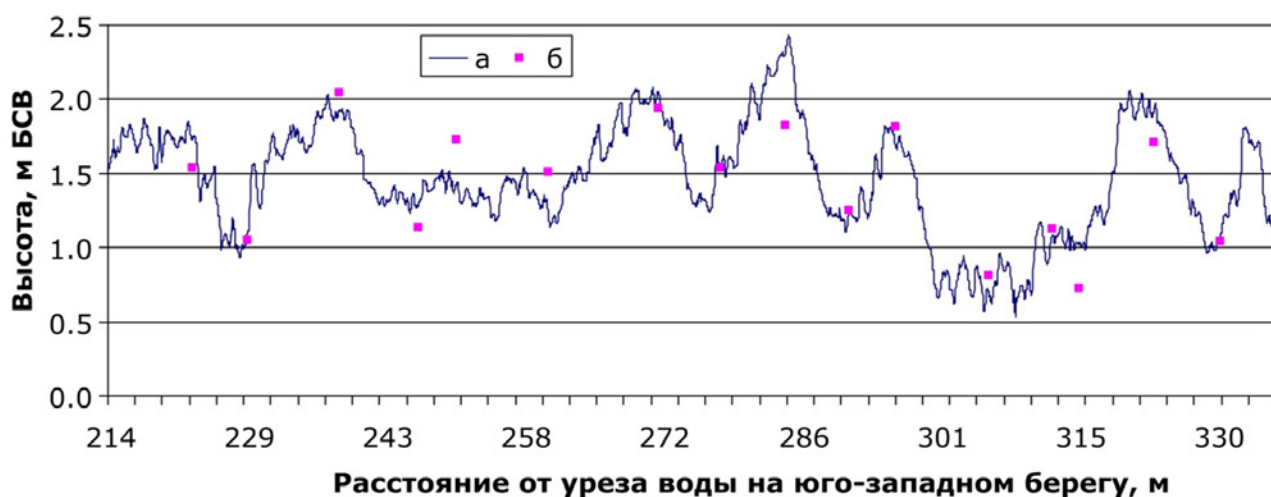
Рис. 5. Сравнение профиля рельефа, полученного из ЦМР, построенной по результатам аэрофотосъемки (а) и измерений отметок высот (б)
