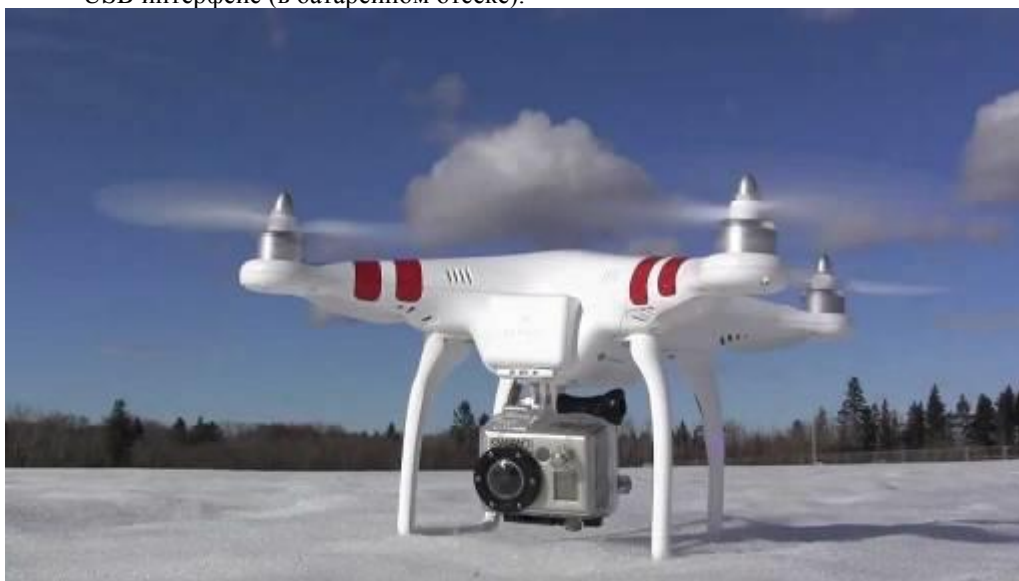
Рис. 2. DJI Phantom с камерой GoPro HD Hero 3
